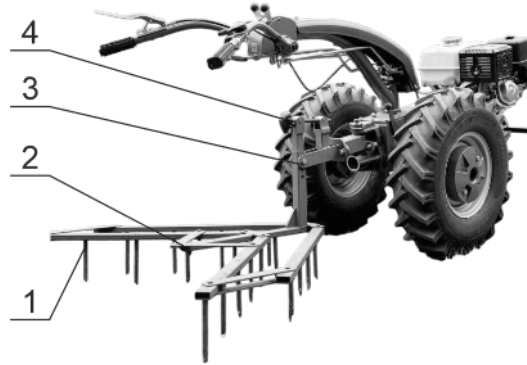
Рисунок 3.3 – Мотоблок в агрегате с бороной
